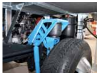
VB Airsuspension: neue Vorderachs-Luftfeder für den Iveco Daily.
