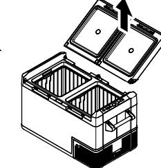
**2.**> Um den Deckel zu öffnen, entriegeln Sie (**A**).**CFF35, CFF45:** Der Deckel kann von beiden Seiten geöffnet werden.> **CFF35, CFF45:** Lösen Sie die Verriegelung an beiden Seiten (**B**) gleichzeitig, um den Deckel abzunehmen.> **CFF12, CFF18, CFF20, CFF70DZ:** Drücken Sie den Deckel über die Deckelanschlagposition (**B**) hinaus.
