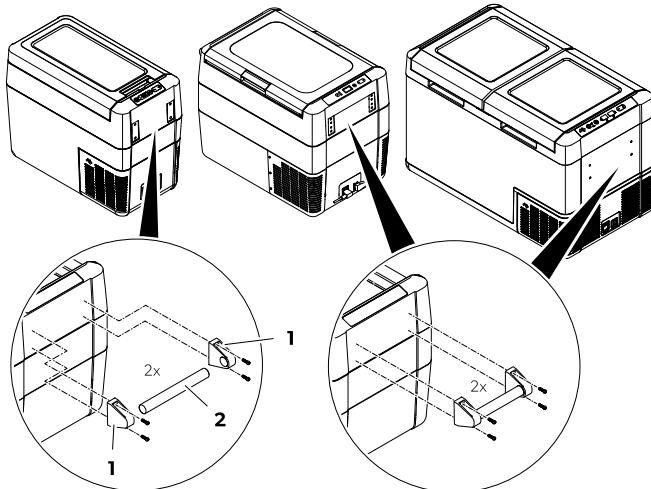
3. Pomocí dodaných šroubů upevněte držák ke 2 podlouhlým otvorům.
