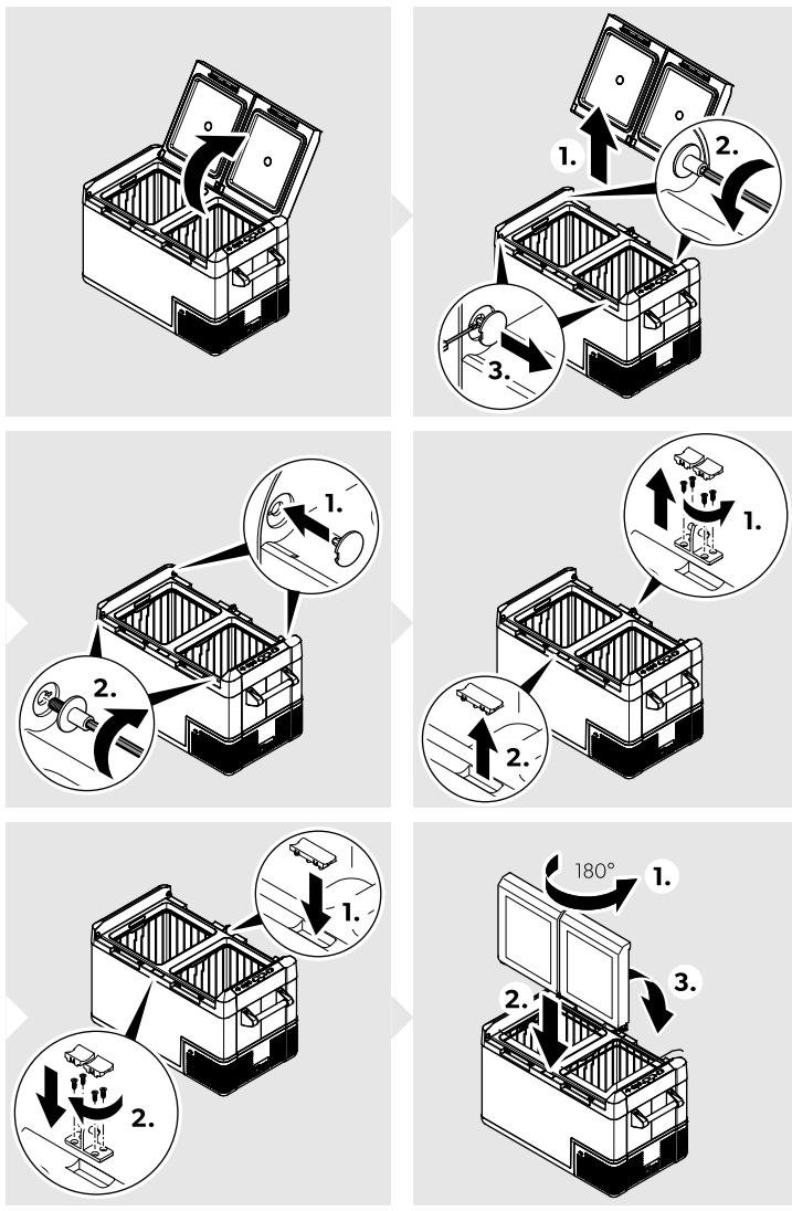
> Při změně směru otevírání víka postupujte podle obrázku ( obr. 6 na stránce 380).
