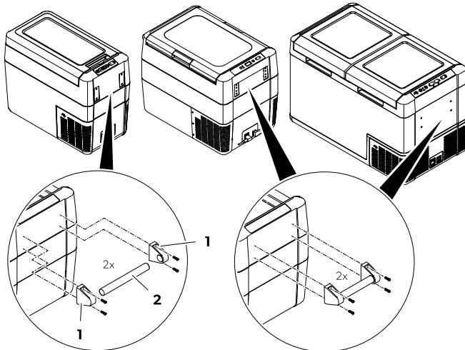
3. Fije el asa con los tornillos incluidos en 2 de los orificios alargados.
