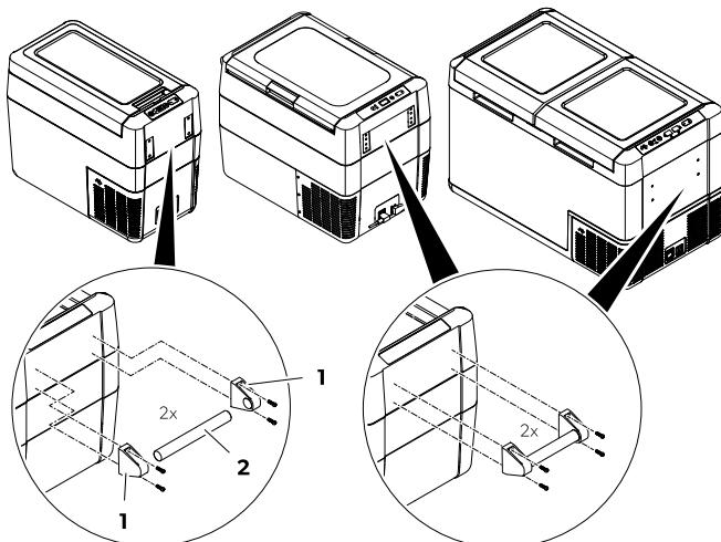
3. Fissare la maniglia in 2 fori sagomati con le viti fornite.
