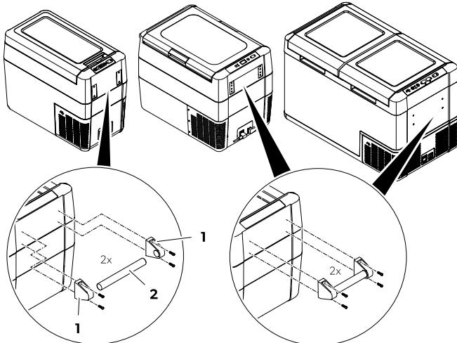
3. Fäst handtaget med de medföljande skruvarna i två av de timglasformade hålen.
