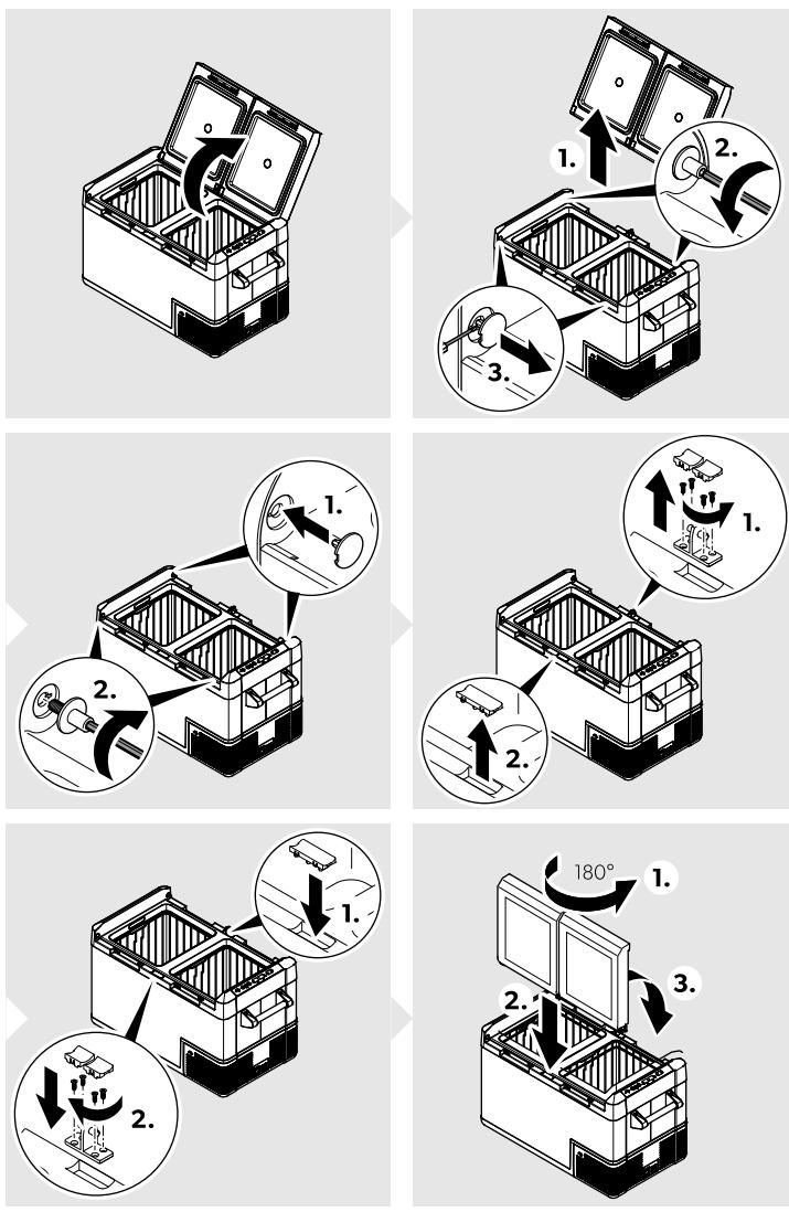
> Smer odpiranja pokrova spremenite na prikazan način ( sl. 6 na strani 491).
