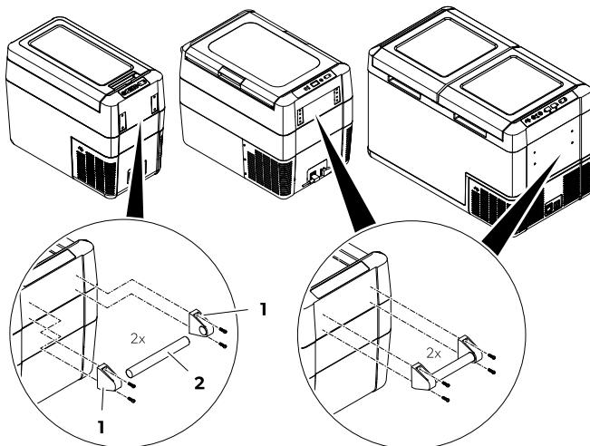
3. Στερεώστε τη λαβή με τις συμπεριλαμβανόμενες βίδες σε 2 οπές σε σχήμα μέσης.
