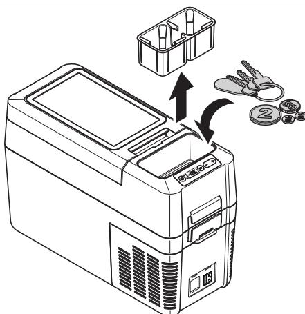
**Korvi (ainult CFF35 ja CFF45) ning vahedetaili (ainult CFF18) eemaldamine**
