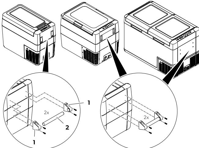
3. Zamocować uchwyt za pomocą dołączonych śrub w 2 podłużnych otworach.
