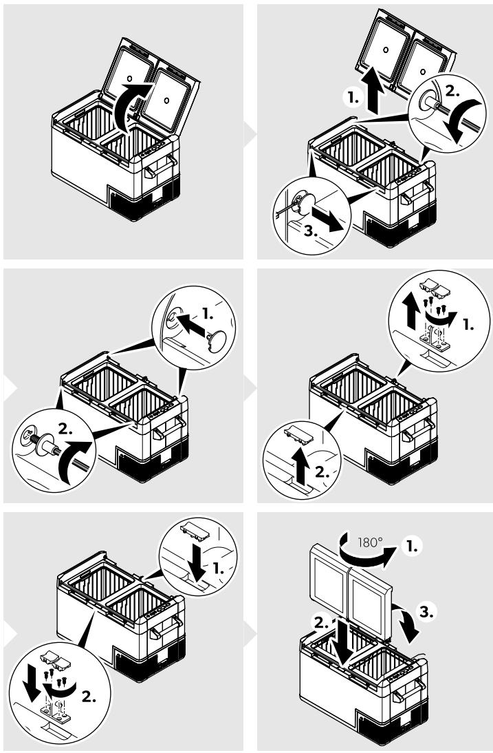
> Gör på följande sätt om du vill vända lockets öppning ( bild. **6** sida 241).
