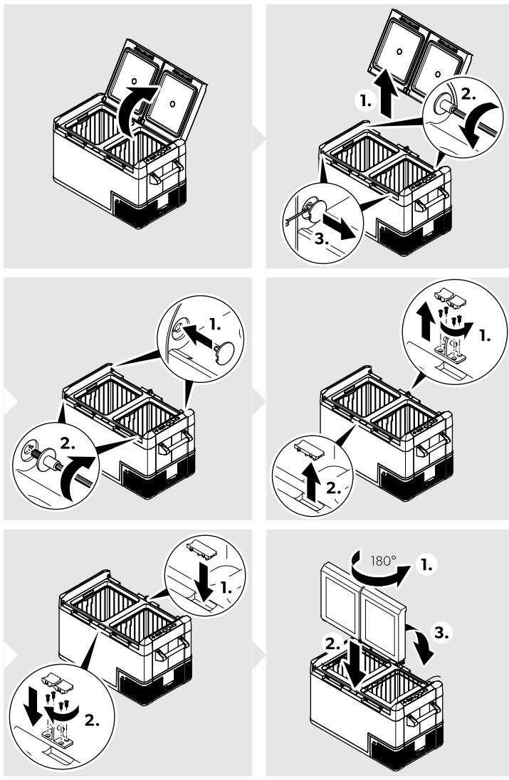
> A fedél nyitási irányának megfordításához a szemléltetett módon járjon el ( . ábra 6 408. oldal ).
