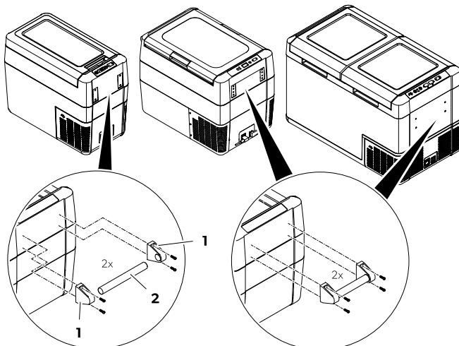
3. Upevnite rukoväť s priloženými skrutkami do 2 otvorov v tvare pása.
