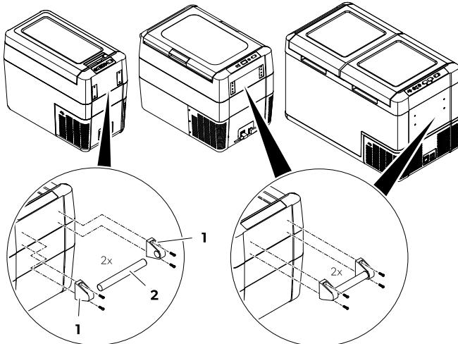
3. Fest håndtaket med de vedlagte skruene i to av de midjeformede hullene.
