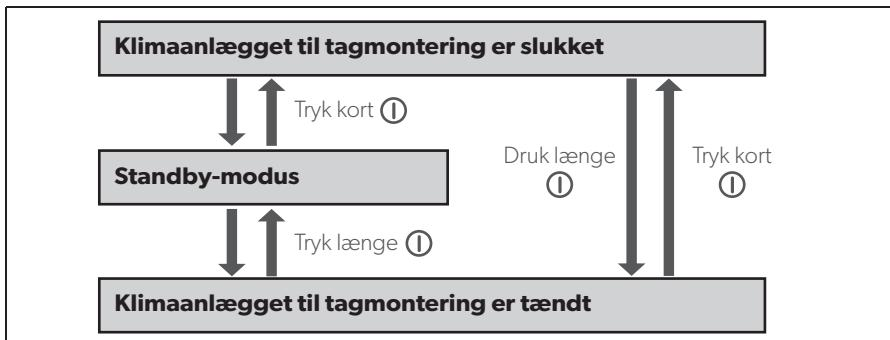
Eksempel: Klimaanlægget til tagmontering er i standby-modus. Det skal slukkes.
