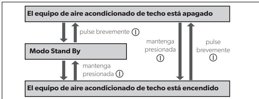
Ejemplo: El equipo de aire acondicionado de techo está en modo Stand By. Debería apagarse.
