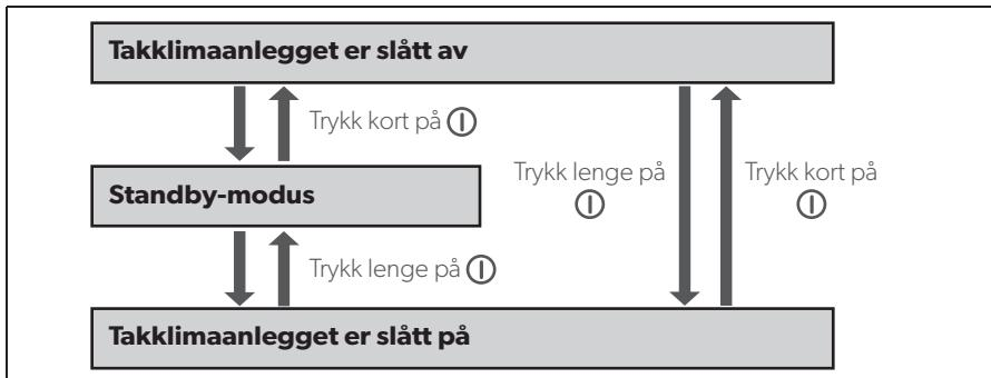
Eksempel: Takklimaanlegget er i standby-modus. Det skal slås av.
