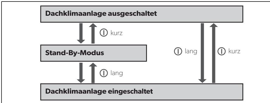
Beispiel: Die Dachklimaanlage ist im Stand-By-Modus. Sie soll ausgeschaltet werden.
