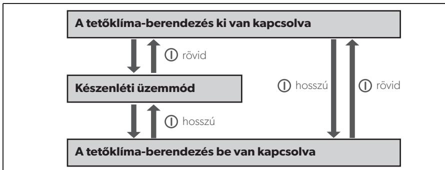
Példa: A tetőklíma-berendezés készenléti állapotban van. Szeretné kikapcsolni.
