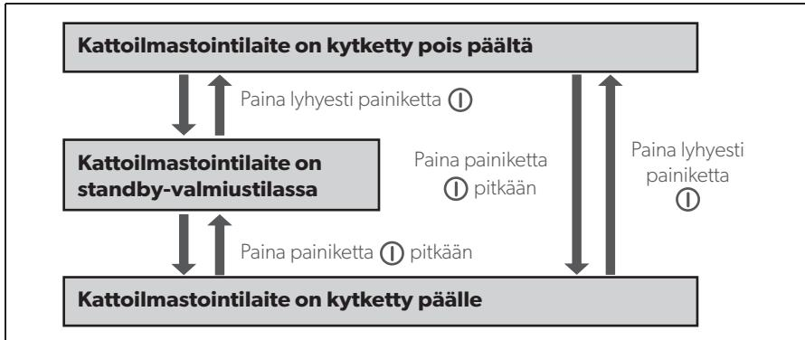
Esimerkki: Kattoilmastointilaite on standby-valmiustilassa. Se halutaan kytkeä pois päältä.
