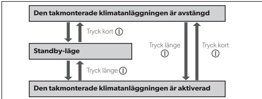
Exempel: Den takmonterade klimatanläggningen är i standby-läge. Den ska stängas av.
