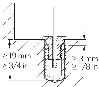
> Supporto Flush Mount (montato a filo, B)
