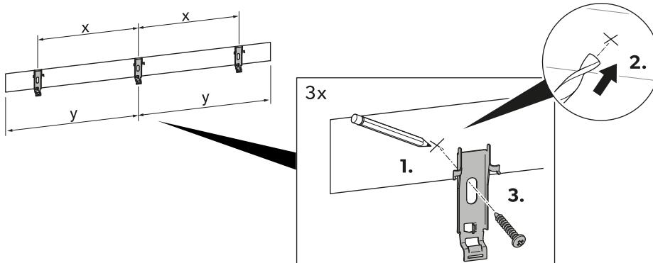
> Fissare l'unità oscurante alle staffe di montaggio.
