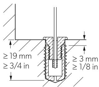
> Halter für Montage der Ausführung „Flush Mount“ (flächenbündig) (B)
