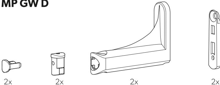
> Halter für Montage der Ausführung „Extended“ (verlängert) mit Führungsdraht (D)
