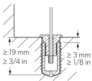
> Flush Mounted -mallinen pinta-asennettava kiristyskappale (B)
