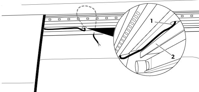
9. Legen Sie das Anschlusskabel in den Spalt oberhalb der oberen Führungsschiene (☞ Abb. 7 auf Seite 16, 2).
