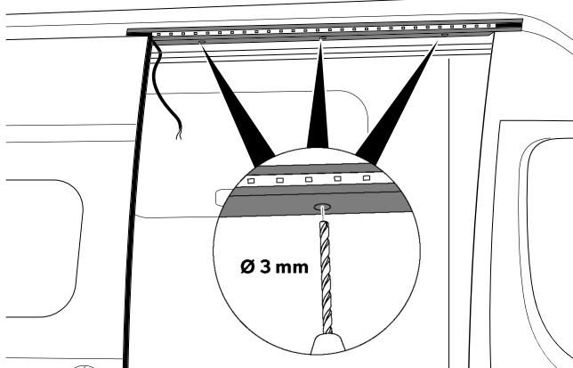
7. Fäst rännan på fordonet med de medföljande skruvarna.
