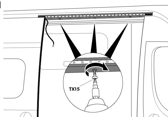
8. Führen Sie das Anschlusskabel durch das vorhandene Bohrloch ( Abb. 7 auf Seite 16, 1) oberhalb der oberen Führungsschiene ( Abb. 7 auf Seite 16, 2) ins Fahrzeug.
