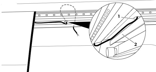
9. Placez le câble de raccordement dans la rainure au-dessus du rail de guidage supérieur ( fig. 7 à la page 24, 2).
