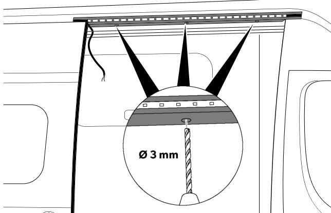
7. Fixez la gouttière au véhicule à l'aide des vis fournies.
