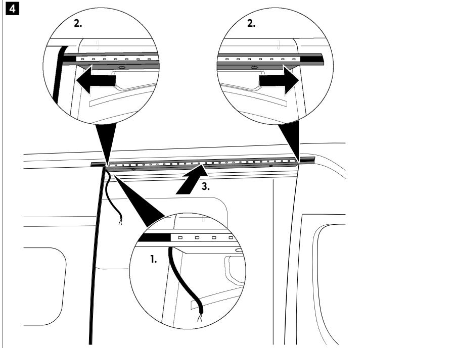
4. Alinee el canalón en el medio de la apertura de la puerta utilizando las superficies inclinadas de ambos extremos del canalón ( fig. **4** en la página 30, **2**).
