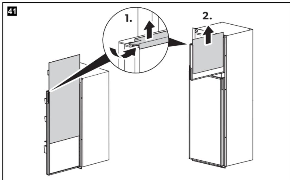
**Installing the door panel**
